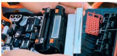
Le smoove est inséré dans le four de la soudeuse. Sous l'effet de la chaleur, il va se rétracter permettant ainsi à la fibre de ne pas casser dans le PBO, ni de perdre de débit.
