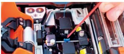
La soudure est la fusion de deux câbles de fibre optique. Dans la soudeuse sont introduites les deux extrémités du câble de fibre optique entre les électrodes et les emplacements bleus.
